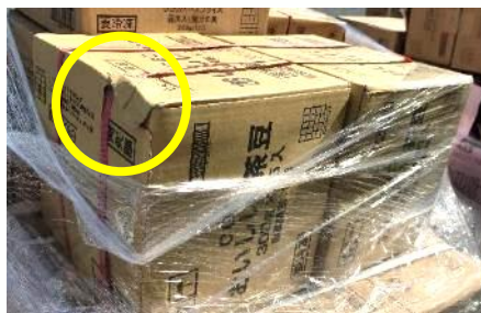
バンド食込みによる破損
