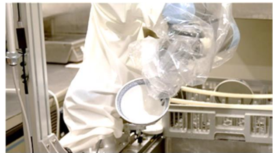
【開発したロボットによる洗浄作業】
