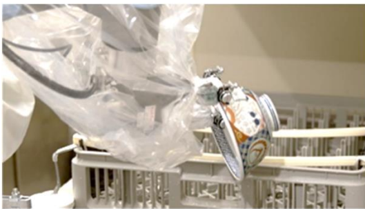
【開発したロボットによる洗浄作業】
