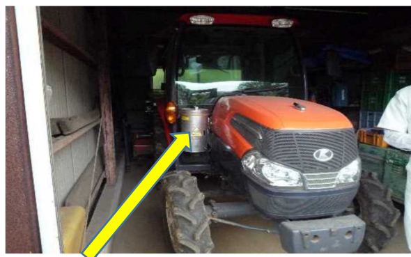
粒剤散布装置の作動忘れ防止のため、作動時は光る
