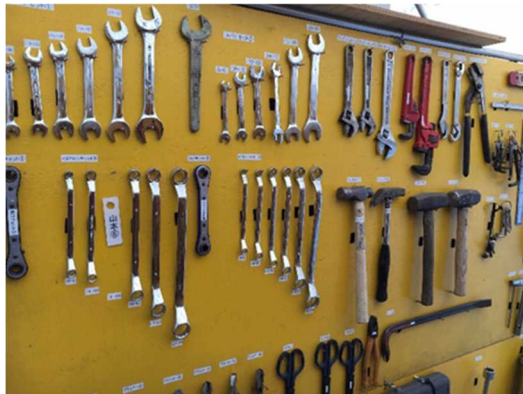
GAPに準拠して「姿置き」で配置された工具類
