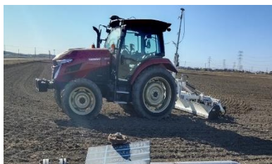
GPS 搭載レーザーレベラー活用
