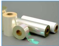
各層の光路差干渉（屈折率×厚み）による特定波長の多重反射を利用
