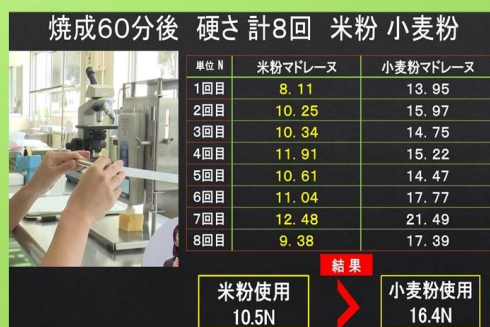
図3 硬度計を用いた実験
