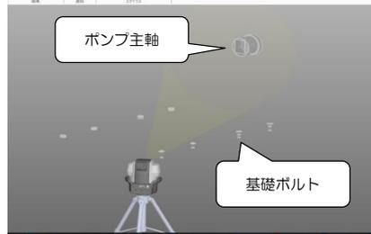
ポンプ主軸と基礎ボルト位置の精密計測
