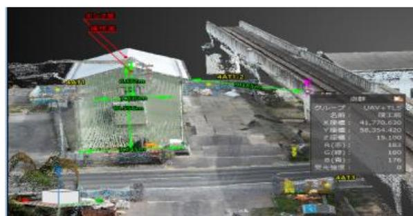
3D測量データによる簡易計測と全自動動態観測
