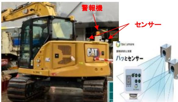
重機接触防止装置「ハットセンサー」
