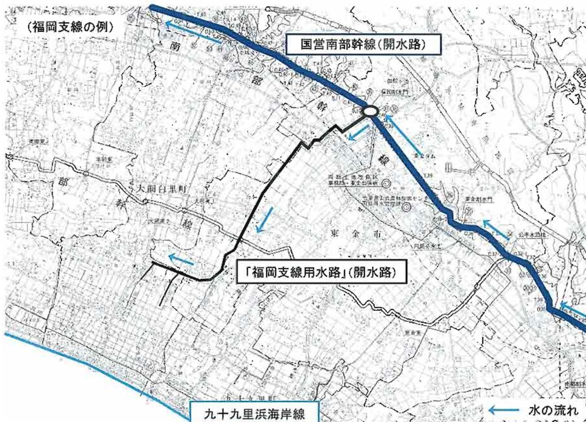
また、下流側の地域では、両総用水の水が届かないため用水の総量が足らず、可能な限り用水を節約する観点から、排水路をせき止め、地下水位を高く保つことで地下浸透を抑制するという工夫（地下水止め）が行われ、広域的に地下水位の高い状態が発生して水田畑利用が阻害される一因となっている。
