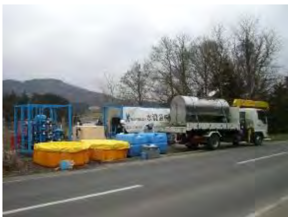
【可搬式海水淡水化装置より、 桜川市給水車への補給状況】
