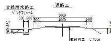
標準断面図 ほ場整備 支線道路工・支線水路工
