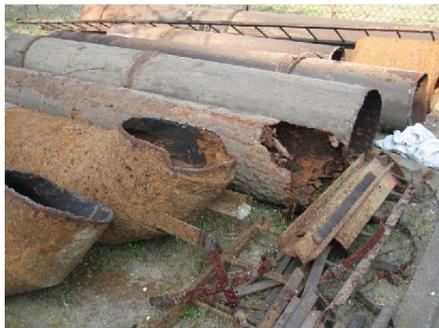
腐食により漏水が発生した吐水槽
