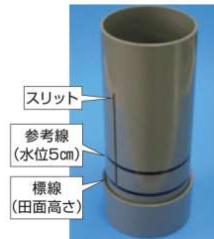
水位水温計 設置マス
