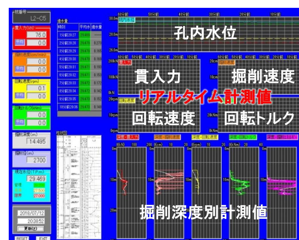
施工管理者用 掘削管理システムモニター画面
