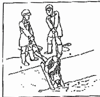
ポンプ投入例
