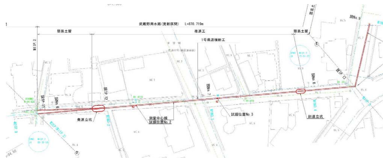
図-1.1.3.2 下流側推進工区間説明図
