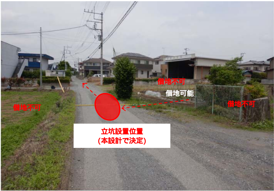
写真-1.1.1.1.8 R5 年度推進工区間 上流側立坑
