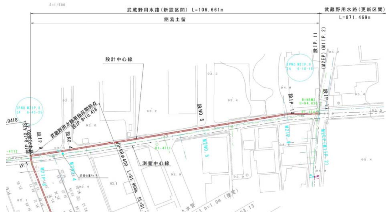
図-1.1.3.1 上流側推進工区間説明図
