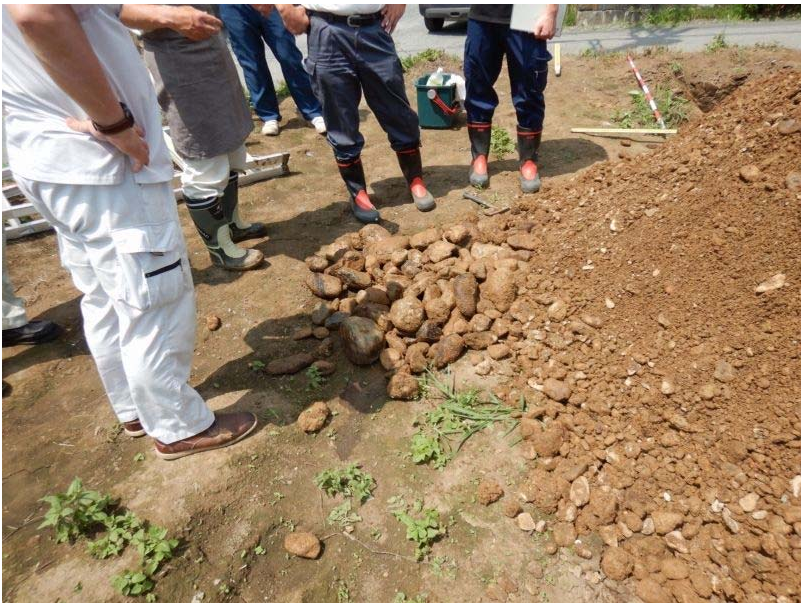
試掘により掘り出された大きな礫 径 7 ~ 20cm 計 112 個の礫種を判定
