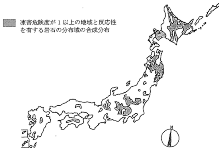
図 凍害と A S R の複合劣化の可能性のある地域 「複合劣化コンクリート構造物の評価と維持管理計画研究委員会 報告書」 2001 年(社)日本コンクリート工学協会 P.64
