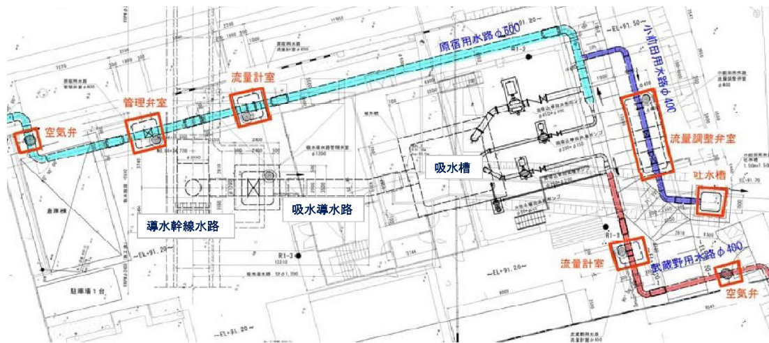
各用水路への配管
