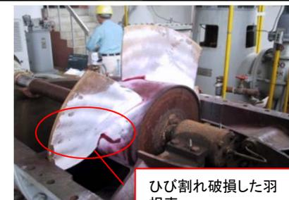
ひび割れ破損した羽根車
