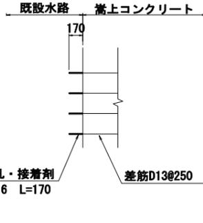
※嵩上げは既設水路の側壁の天端に削孔を行い、接着剤を充填して鉄筋を固定する。
