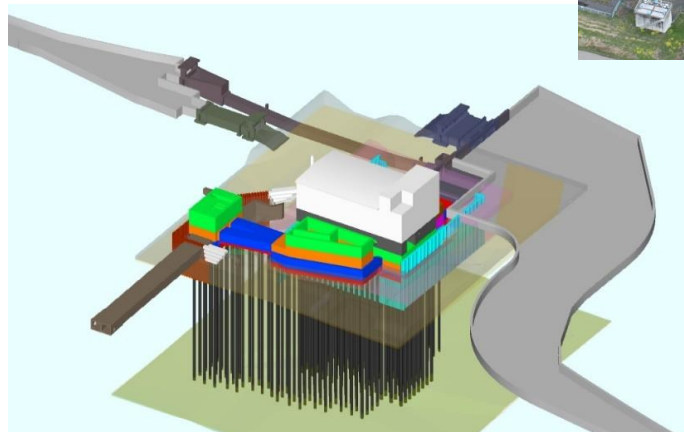
新しい排水機場の3Dスケルトンモデル
