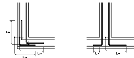
図12.1 擁壁の鉄筋の定着長さ
