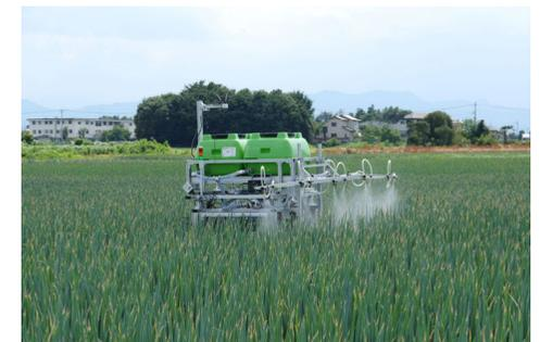
ねぎの自動農薬散布ロボット
