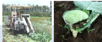
自動収穫機での収穫に失敗したキャベツ
