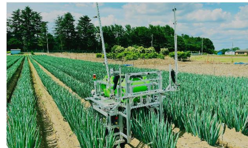
ねぎの自動農薬散布ロボット
