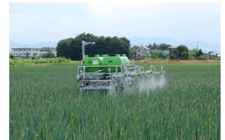
ねぎの自動農薬散布ロボット
