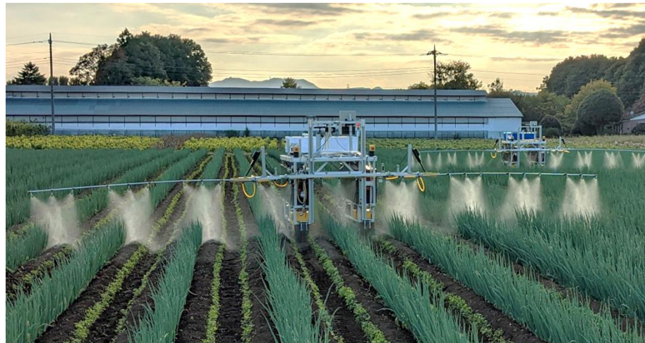
図1 自律走行型ロボットによる農薬散布の様子
