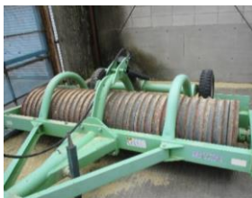
踏圧効果の高いK型ローラーを用い、麦踏み回数を削減
