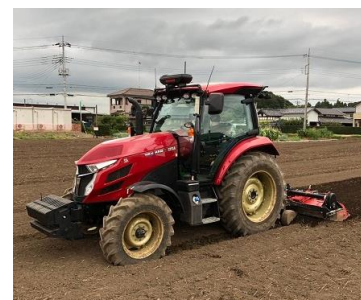
ロボットトラクターによる耕起作業
