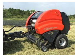
圧縮・成型（牧草用ロールベアラ）
