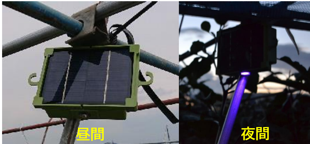
紫色LED照射機ソーラー電源タイプ (土着天敵誘因)
