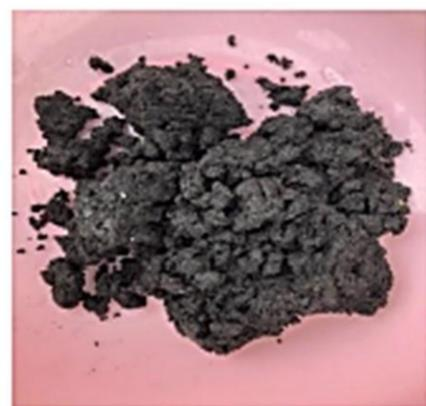
第1図 試験に用いた下水汚泥
