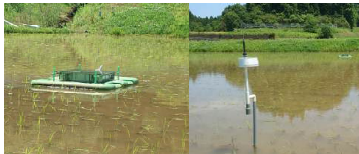
有機米栽培で活躍！ 抑草効果があるアイガモロボと水位センサー
