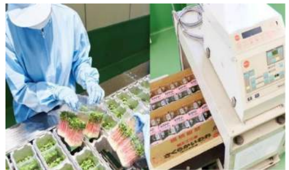
目視、金属探知機での異物混入検査
