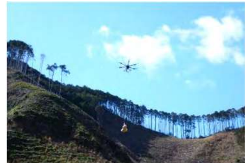
開発した林業用大型ドローンの活用により、約25kgまで苗木等の資材運搬が可能となり、作業員の負担軽減や効率化に繋げている
