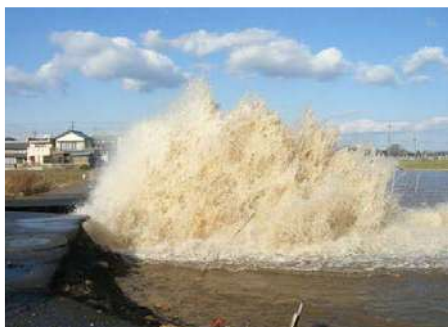
【管水路の突発事故（管の破裂）】
