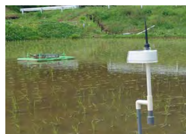
有機米栽培で活躍！ アイガモロボと 水位センサー
