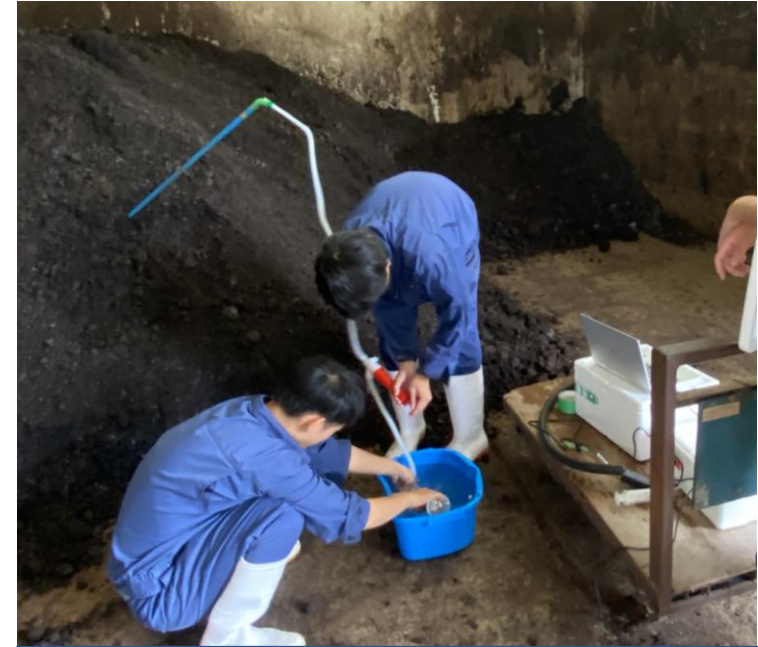
堆積堆肥中の滞留ガスを ポンプと水上置換で捕集
