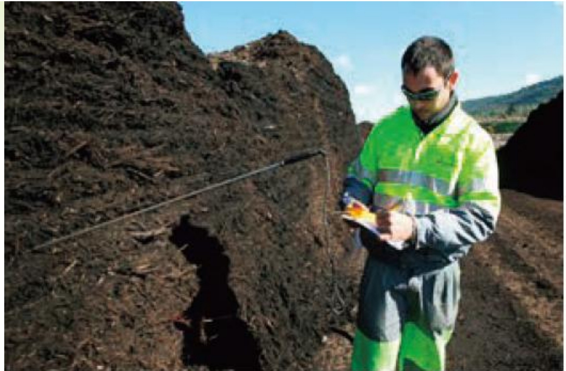
写真-3 標準化されている温度計の設置方法
