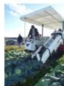
キャベツ収穫機による収穫 (兵庫県神戸市)
