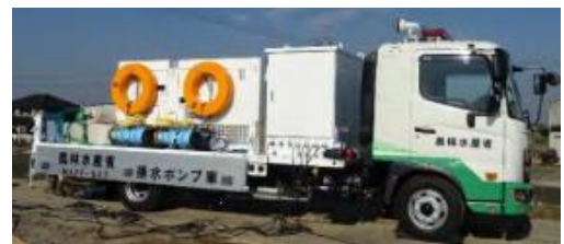
排水ポンプ車【土地改良技術事務所に配備】
