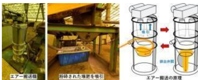
図7 ペレット原料供給の加速化のためエア搬送
