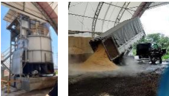
図14 左：密閉縦型堆肥化装置 右：もみ殻搬入の様子
