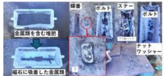
図10 ペレット製造工程で除去されたの堆肥中金属類
