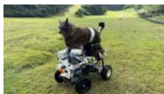
株式会社ウルフ・カムイ 野生動物撃退装置「モンスターウルフ」 オオカミを模した装置で野生生物を撃退。MITRAコンセプトと組み合わせた「ウルフムーバー」を大阪経済大学・NTTドコモとともに実証中
