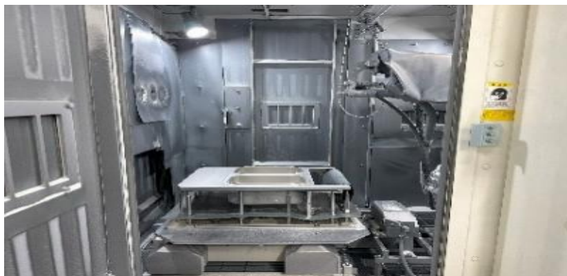
↑ 原料を入れるタンク、シリンダー部分の自動表面加工する設備
