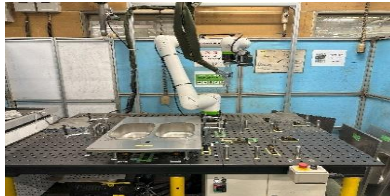
↑ 原料を入れるタンク部分の自動溶接をする設備
