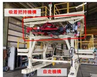
パネルライニング 自動施工台車
