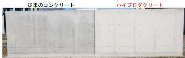
写真1 構築した壁部材の出来栄
