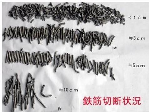
鉄筋の切断状況
