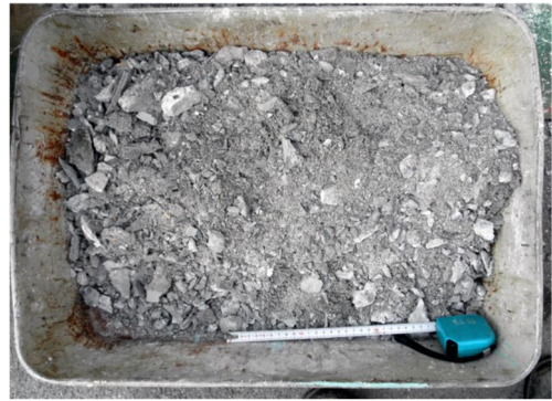
コンクリート破砕状況
