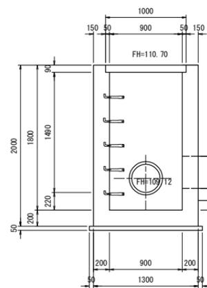
既設側溝復旧工 断面図
