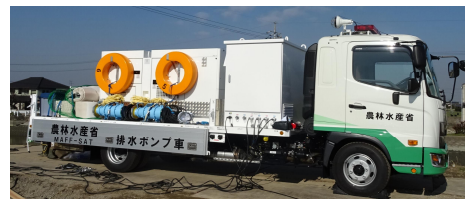
排水ポンプ車
