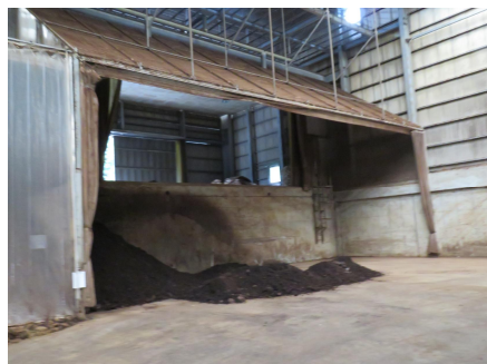
牛糞搬入・完成堆肥と混合 隣接する発酵槽へ
