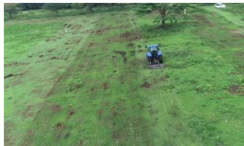
鳥取県・伯耆町 トラクタ装着型フレールモア
