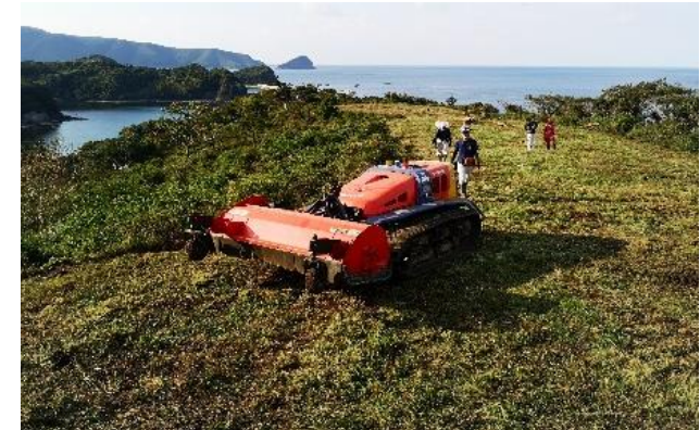
島根県・海士町 無線トラクタ装着型フレールモアによる 現地実演
