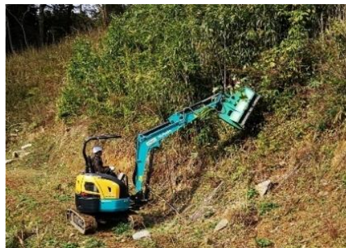
島根県・大田市 油圧ショベル装着型フレールモア
