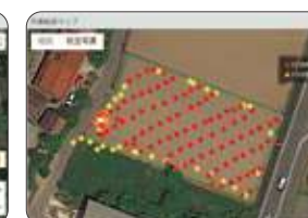
サブソイラの暗渠作業の軌跡
